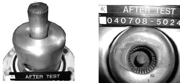
图 5 快速接地开关短路关合后的动、静触头
